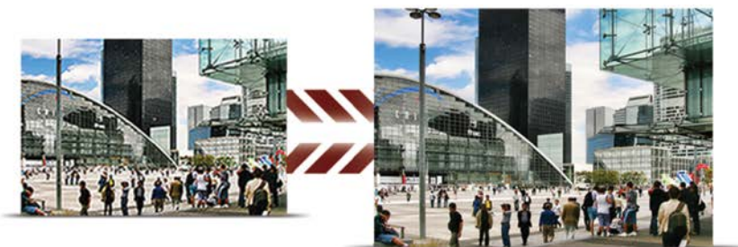
Rys. 3. Porównanie jakości obrazu analogowego o standardowej rozdzielczości oraz AHD 1,3 Mpx
