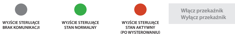
Rys. 6. Ikona wyjścia sterującego w różnych stanach
