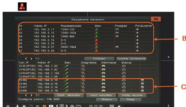
Fot. 3. Okno konfiguracji kamer w rejestratorze
