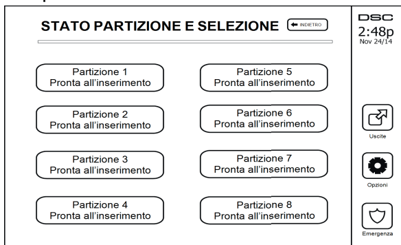
Figura 11- Stato delle partizione
