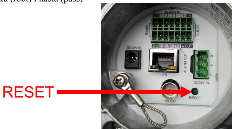
Przycisk *RESET* znajduje w miejscu wskazanym na powyższym rysunku.
