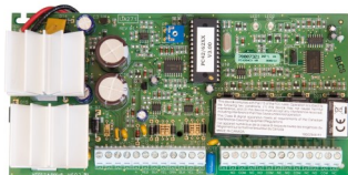
KT-PC4204 – moduł 4 przekaźników lub jako dodatkowy zasilacz
