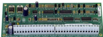
KT-PC4116 – moduł 16 wejść parametrycznych linii dozorowych
