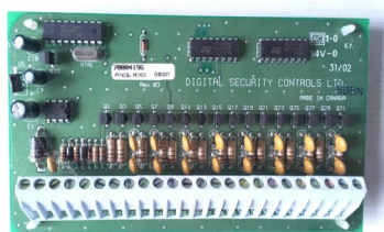
KT-PC4216 – moduł 16 tranzystorowych wyjść sterujących
