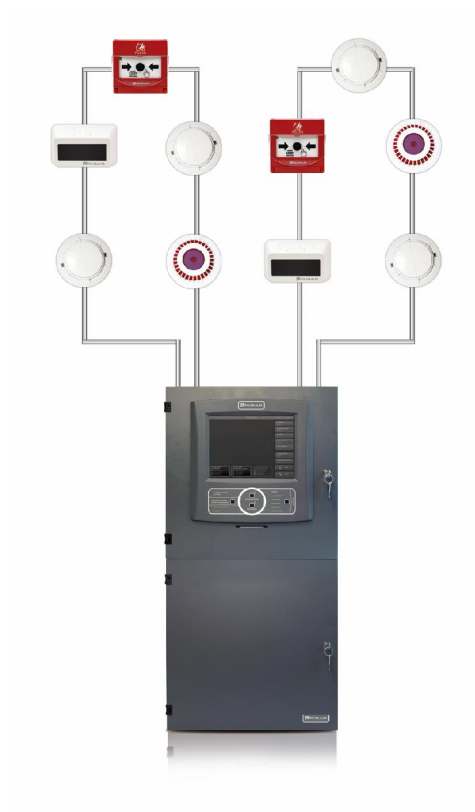
Rys. 2.2/1 Przykładowa konfiguracja sytemu POLON 6000 w architekturze nierozproszonej (tradycyjnej)
