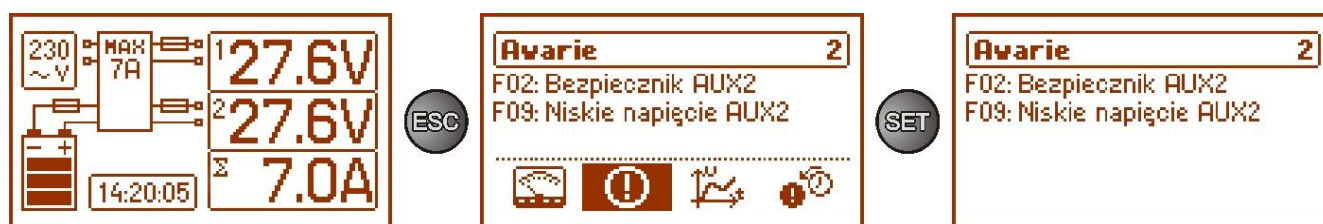
Rys. 12. Ekran – bieżące awarie zasilacza.
