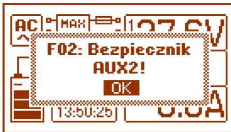
Rys. 11. Komunikat sygnalizujący przepalenie bezpiecznika na wyjściu AUX2.
