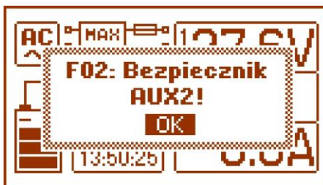
Rys. 11. Komunikat sygnalizujący przepalenie bezpiecznika na wyjściu AUX2.
