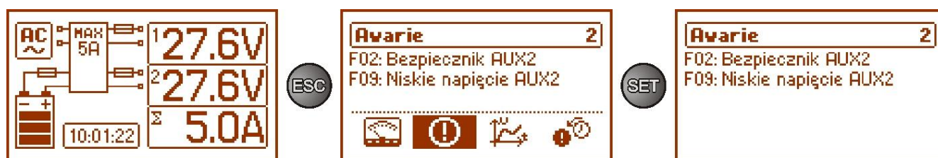
Rys. 12. Ekran – bieżące awarie zasilacza.
