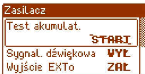
Rys. 28. Test akumulatorów – nieaktywny.
