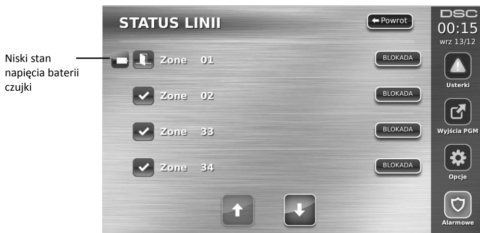
Rysunek 9 - Niski stan napięcia baterii czujki bezprzewodowej.
